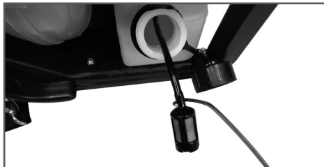
Рис. 22 Извлечение топливного фильтра
