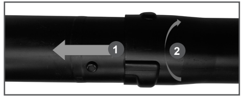
Рис. 6 Соединение напорных труб
